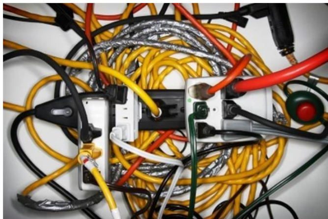
Hình 1.22: Sử dụng 1 ổ cắm cho qua nhiều thiết bị điện
