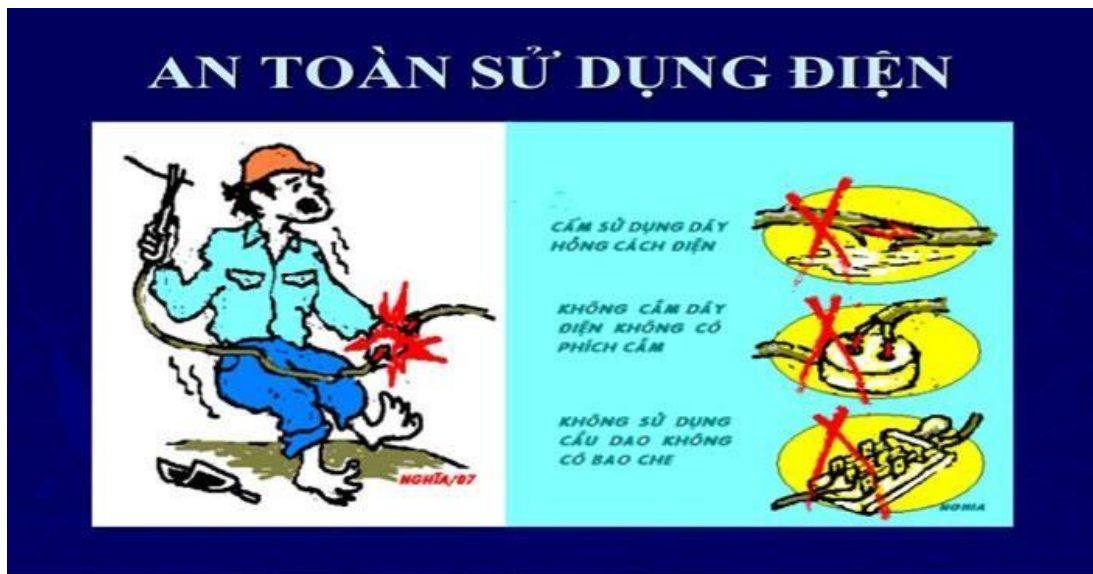
Hình 1.24: Quy tắc sử dụng điện an toàn Từ đó, nắm rõ các quy tắc an toàn điện như sau:
