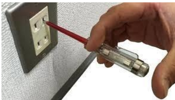
Hình 1.18: Sự cố điện giật do sử dụng các thiết bị đo lường không đúng cách
