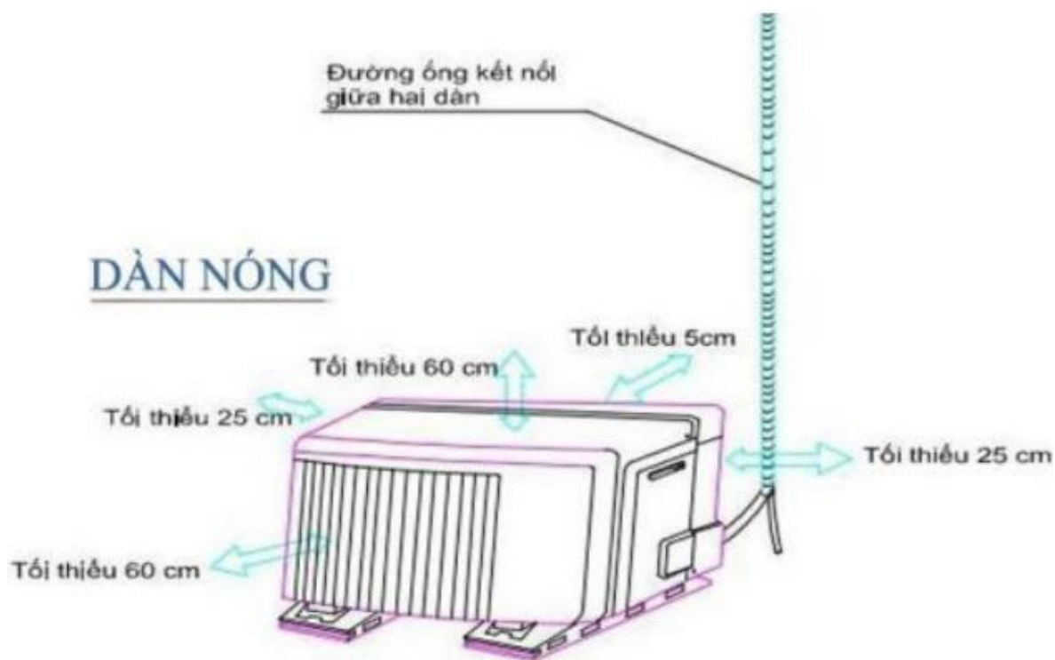
Hình 11.6: Lắp đặt dàn nóng.
