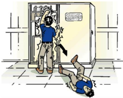
Hình 1.17: Sự cố điện giật do chạm trực tiếp vào các thiết bị điện trong lúc hoạt động.
