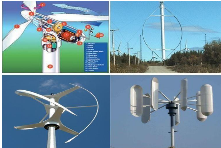
Hình 3.12: Các turbin gió để phát điện.
