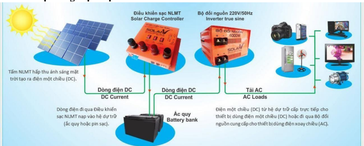
Hình 3.3: Sơ đồ hệ thống điện mặt trời
