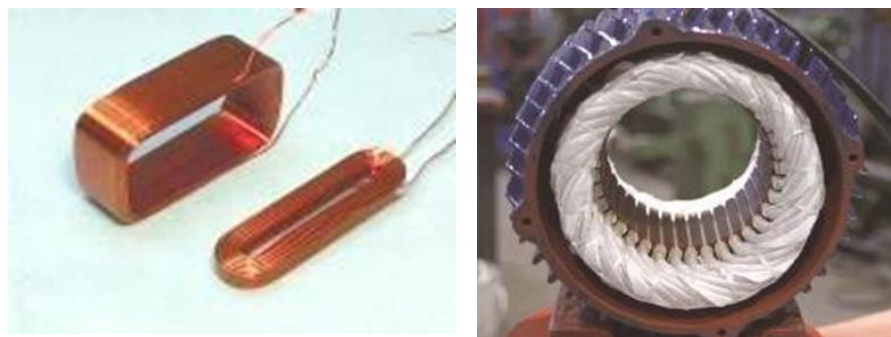
Hình 3.2. Dây quấn của stato động cơ không đồng bộ 3 pha
