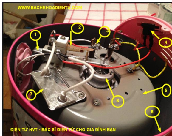
Hình 1.6. Cấu tạo bên trong nồi cơm điện.
