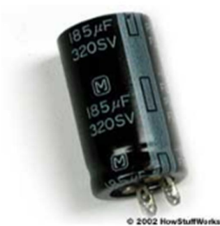
Tụ hoá ghi điện dung là 185 \mu\text{F} / 320 V
