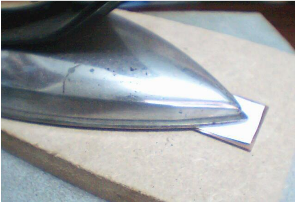
Hình 2.19. Dùng bàn là để ủi mạch
