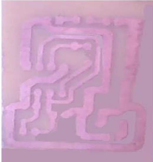
Hình 2.24. Mạch sau khi rửa Fe_2Cl_3
