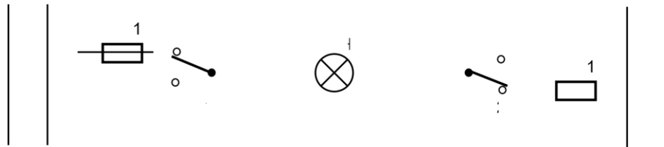
HÌNH 3.60: SƠ ĐỒ NGUYÊN LÝ MẠCH ĐÉN CẦU THANG
