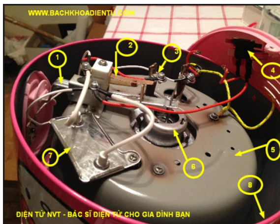
Hình 1.6. Cấu tạo bên trong nồi cơm điện.
