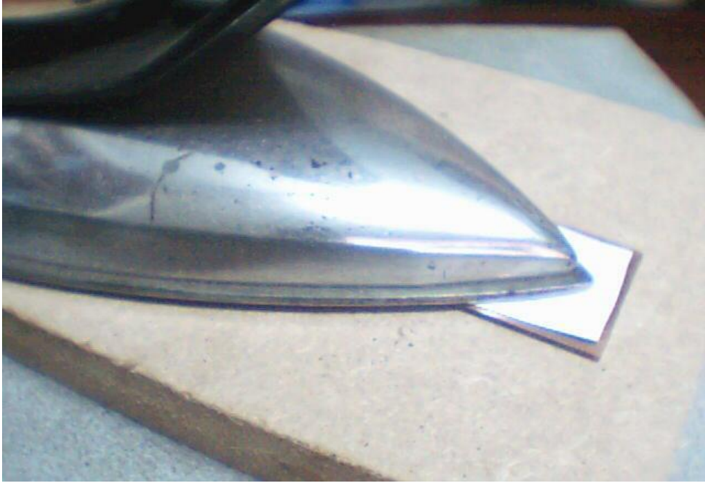
Hình 2.19. Dùng bàn là để ủi mạch
