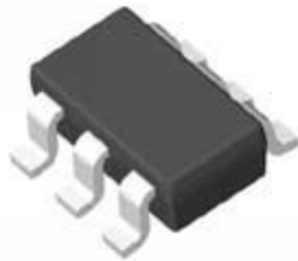
Hình 1.32: Hình dáng và cấu trúc các chân IC AD7414
