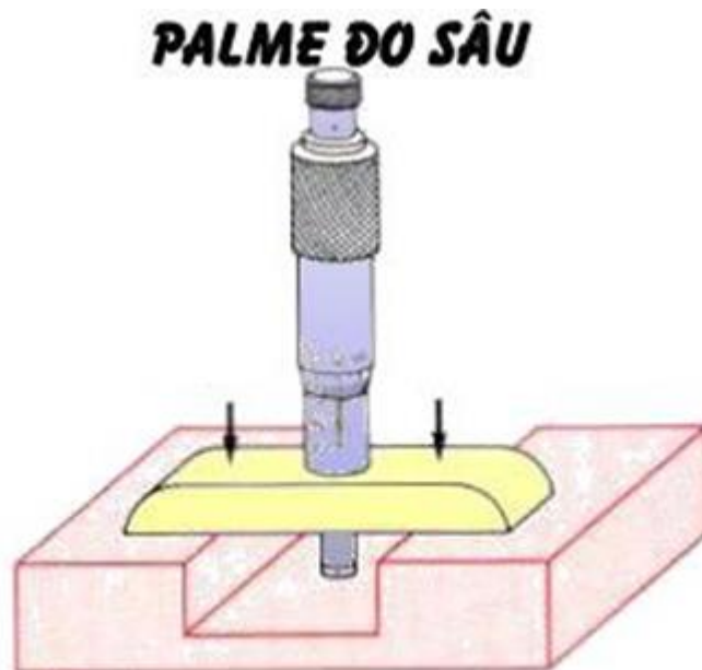
Hình 3.15 Kiểm tra bằng thước panme đo sâu
