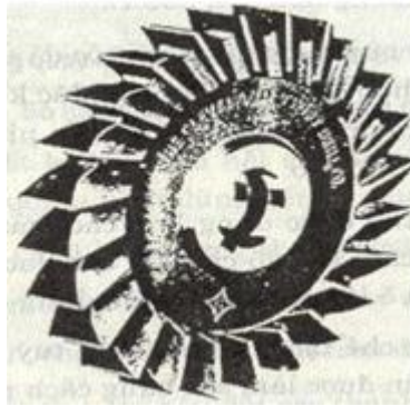
Hình 2.2 Cấu tạo dao phay đĩa
