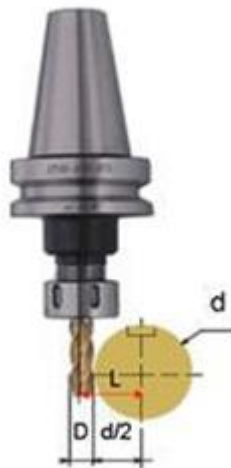
Hình 3.11 Điều chỉnh tâm phôi và dao
