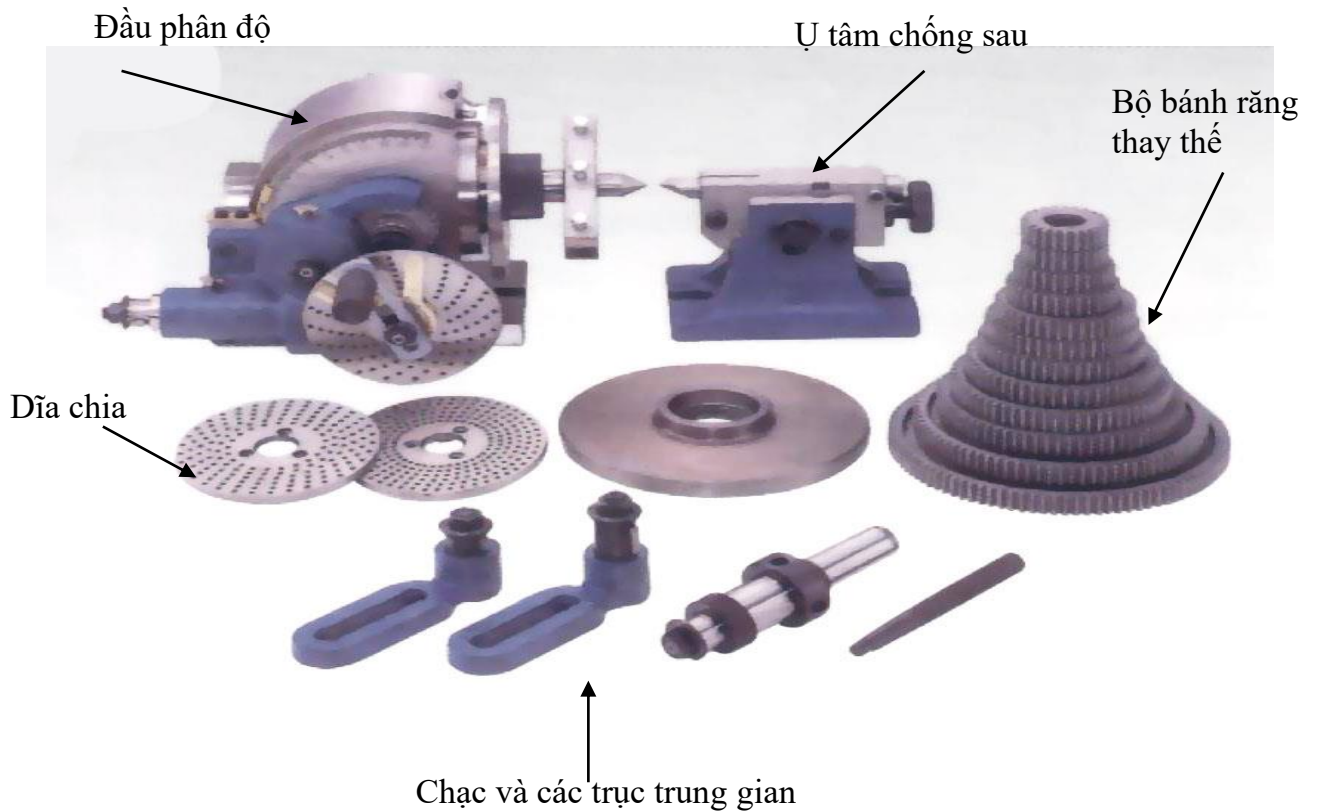
Hình 5.2 Phụ tùng kèm theo của đầu phân độ vạn năng
