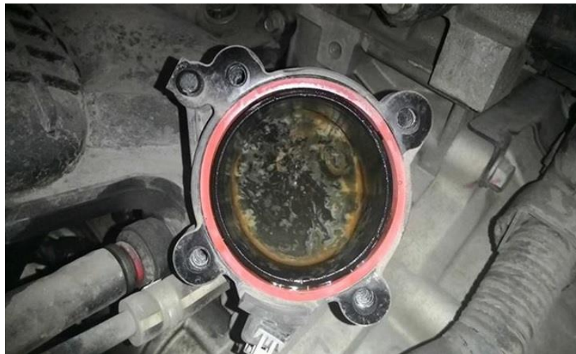
Hình 1.8 Hư hỏng chi tiết do bị ăn mòn
