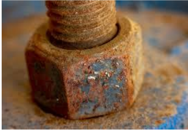
Hình 1.7 Hư hỏng chi tiết do ô - xy hóa
