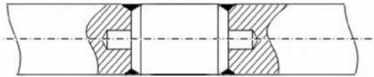
Hình 3.5: Phục hồi trục gãy có đoạn nối thêm
