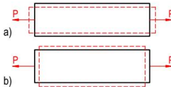
Hình 2.1.6: Thanh chịu kéo hay nén
