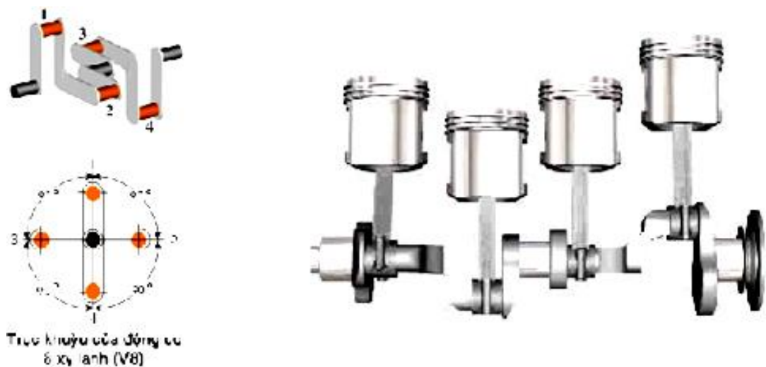
Hình 4.4: Cấu tạo trục khuỷu thanh truyền 8 xi lanh
