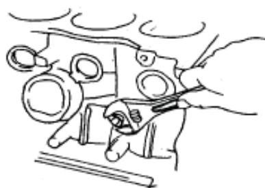
Lắp cảm biến áp suất dầu
