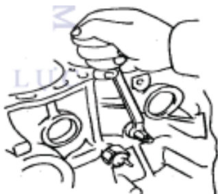
Lắp nút xả nước
