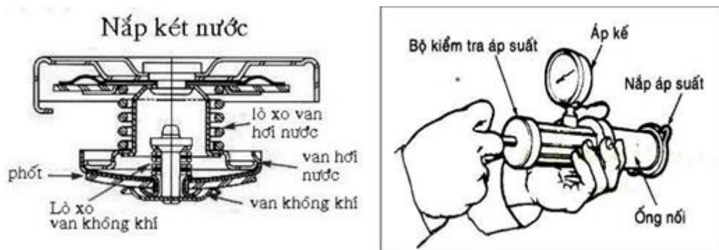
Hình 6.3: Kiểm tra nắp két nước.
