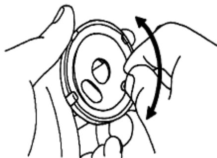
Hình 6.24: Kiểm tra mâm chia điện
