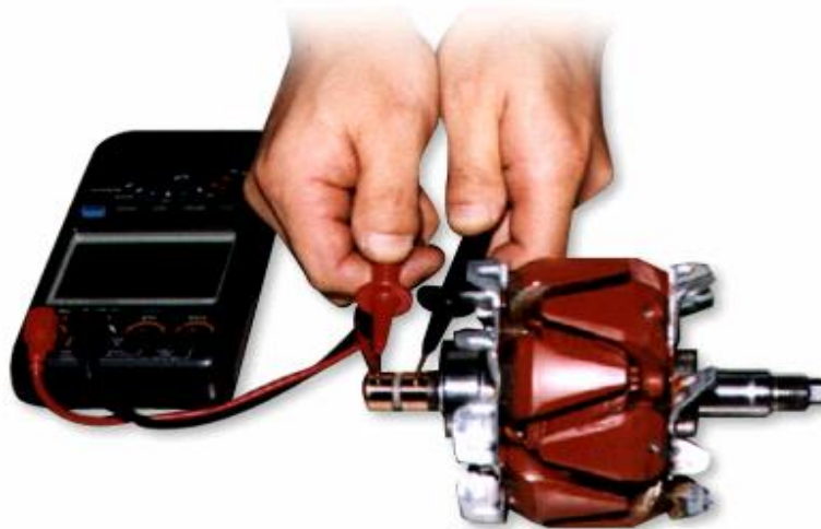
Hình 4.23: Kiểm tra sự thông mạch cuộn dây rotor
