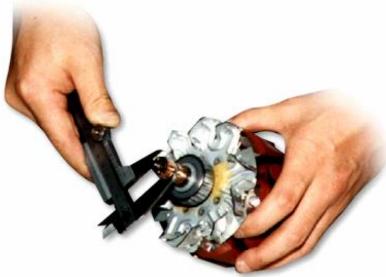
Hình 4.17 : Kiểm tra độ côn của rotor
