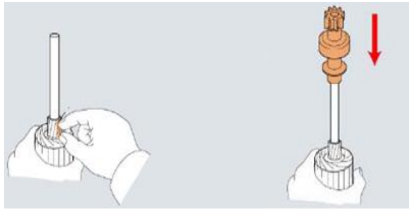
Hình 5.50: Lắp khớp một chiều
