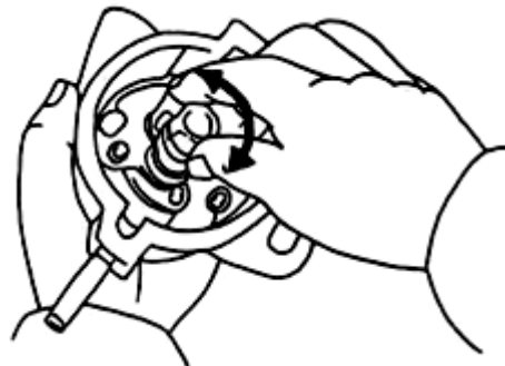
Hình 6.23: Kiểm tra cam chia điện
