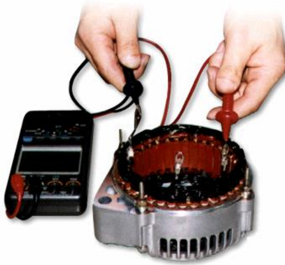
Hình 4.20. Kiểm tra sự thông mạch cuộn stator
