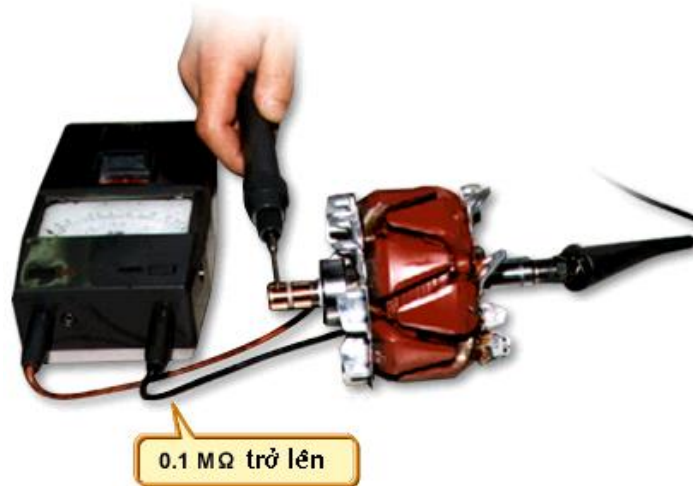
Hình 4.22: Kiểm tra sự cách mass cuộn dây rotor
