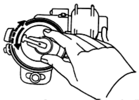
Hình 6.26: Kiểm tra bộ tiết chế góc đánh lửa sớm ly tâm
