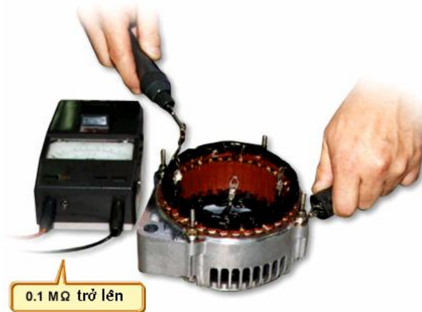
Hình 19. Kiểm tra sự cách mass stator
