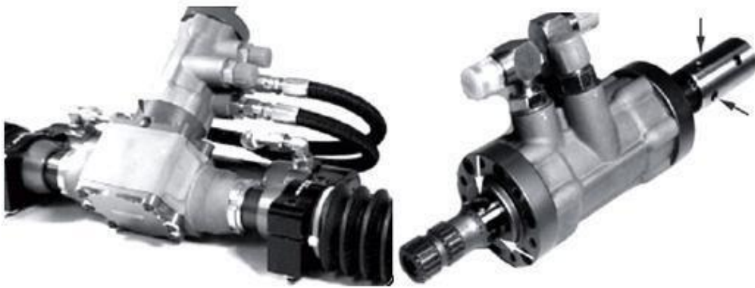
Hình 5.11: Hình dáng bên ngoài của hai bộ trợ lực dùng van xoay lắp đặt trên cơ cấu lái loại thanh răng – bánh răng Khi xe đi thẳng (tại vị trí trung gian).
