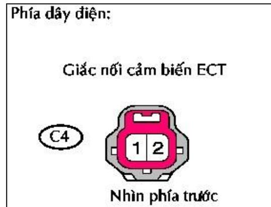
**Xác nhận sự kết nối tốt với cảm biến. Nếu tốt hãy thay thế cảm biến nhiệt độ nước làm mát động cơ.**
