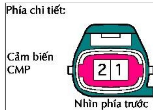
Thay thế cảm biến vị trí trục cam
