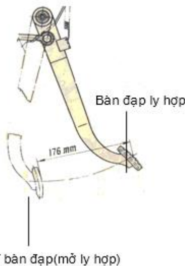
Hình 5.8: Kiểm tra hành trình công tác của bàn đạp
