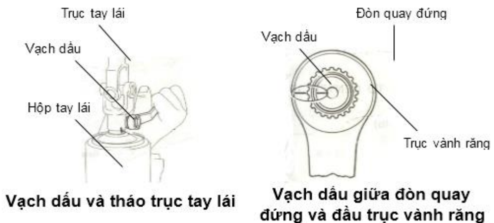
Hình 5.19: Lắp đúng dấu các chi tiết của hệ thống lái ô tô
