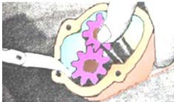
Hình 3.2: Kiểm tra khe hở giữa đỉnh răng và thành vỏ bơm
