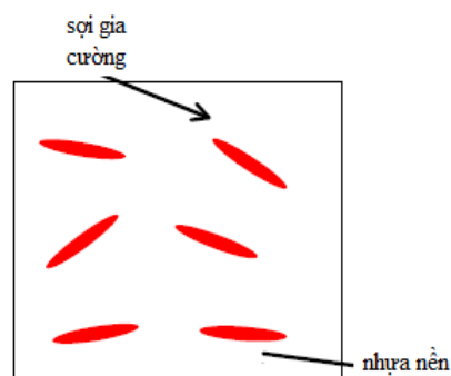
Hình 3.5 pha gia cường và pha nền của composit đơn giản
