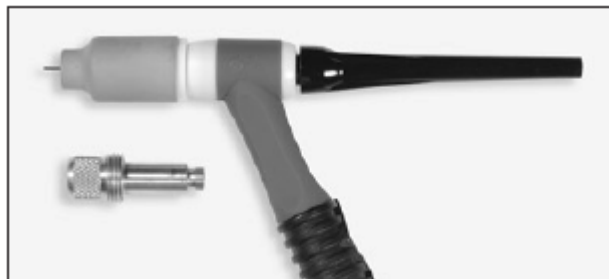
Hình 4.10 : đuốc hàn sử dụng ống hội tụ để giảm sự cuộn xoáy của dòng khí bảo vệ
