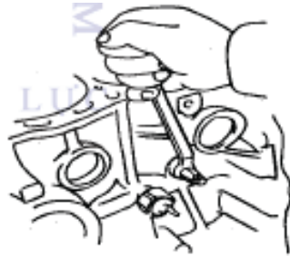
Lắp nút xả nước
