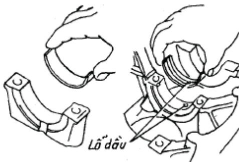
Lắp bạc vào thân máy và gôỉ đỡ
