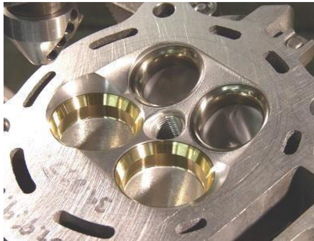
Hình 3.6: Cấu tạo đế xupáp
