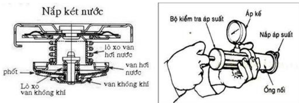
Hình 6.3: Kiểm tra nắp két nước.
