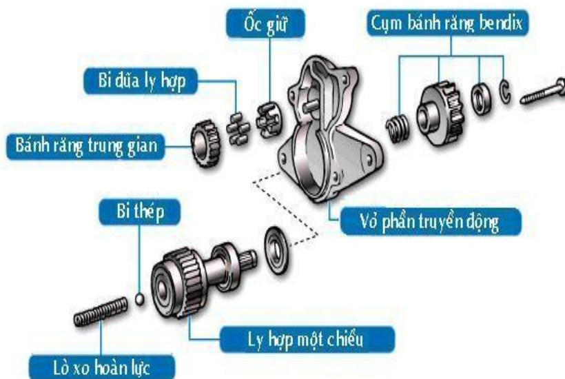
Hình 5.48: Lắp bánh răng Bendix
