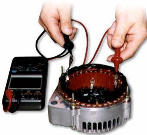
Hình 4.20. Kiểm tra sự thông mạch cuộn stator - Dùng đèn hoặc đồng hồ để kiểm tra, ta lần lượt đặt que dò vào các đầu dây pha. Nếu đèn sáng hoặc đồng báo là tốt.
