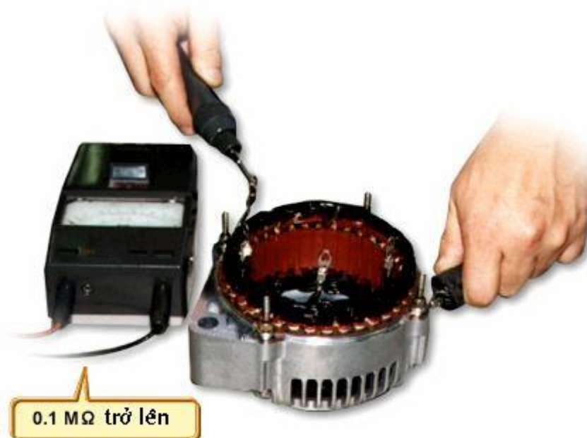
Hình 19. Kiểm tra sự cách mass stator
