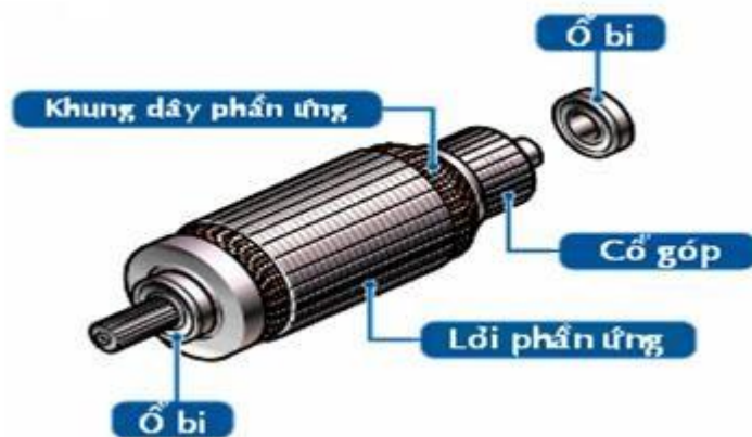
Hình 5.6: Cấu tạo phần ứng
