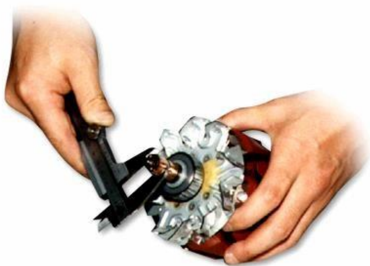
Hình 4.17 : Kiểm tra độ côn của rotor
