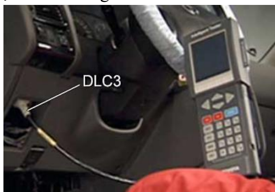
Hình 44. Đọc mã lỗi bằng thiết bị.
