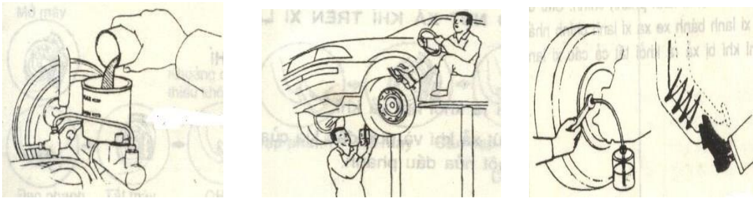
Hình 5 - 27. Xả không khí trong hệ thống phanh thủy lực
