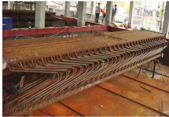
Hình 2.4: Dàn lạnh xương cá (trong hệ thống sản xuất đá cây).
