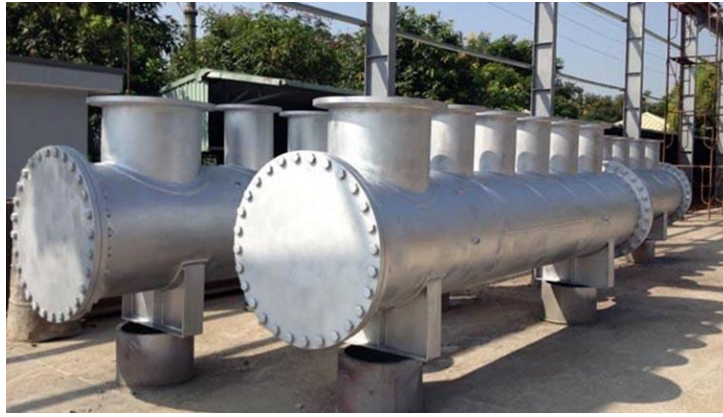
Hình 2.2: Thiết bị ngưng tụ công nghiệp (hay Bình ngưng).
