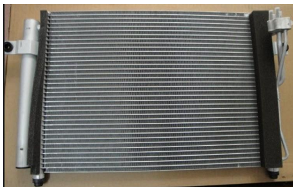
Hình 2.13: Giàn nóng và cấu tạo giàn nóng.
