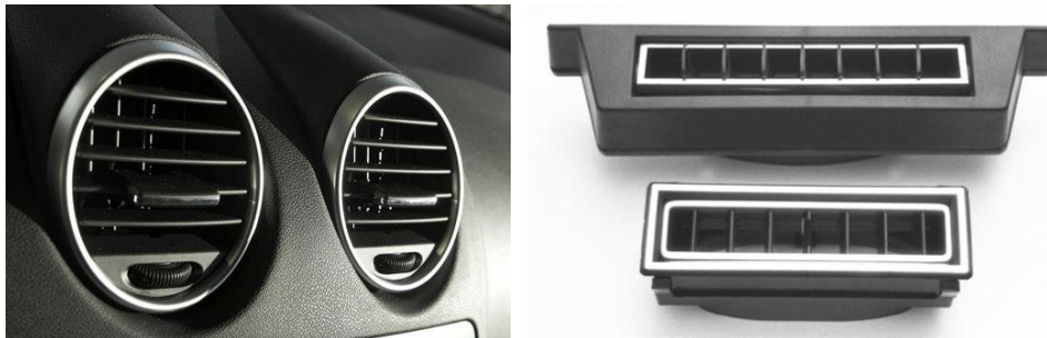
Hình 1.7: Cánh điều tiết dàn lạnh của ô tô 4 chỗ và 7 chỗ.
