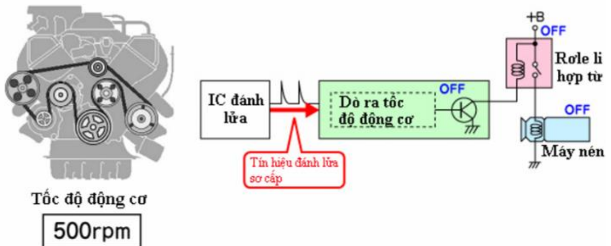
Hình 2.31: Sơ đồ nguyên lý hệ thống điều khiển tốc độ động cơ.
