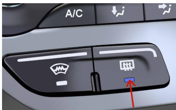
Hình 2.28: Điều khiển tan băng trên ô tô.
