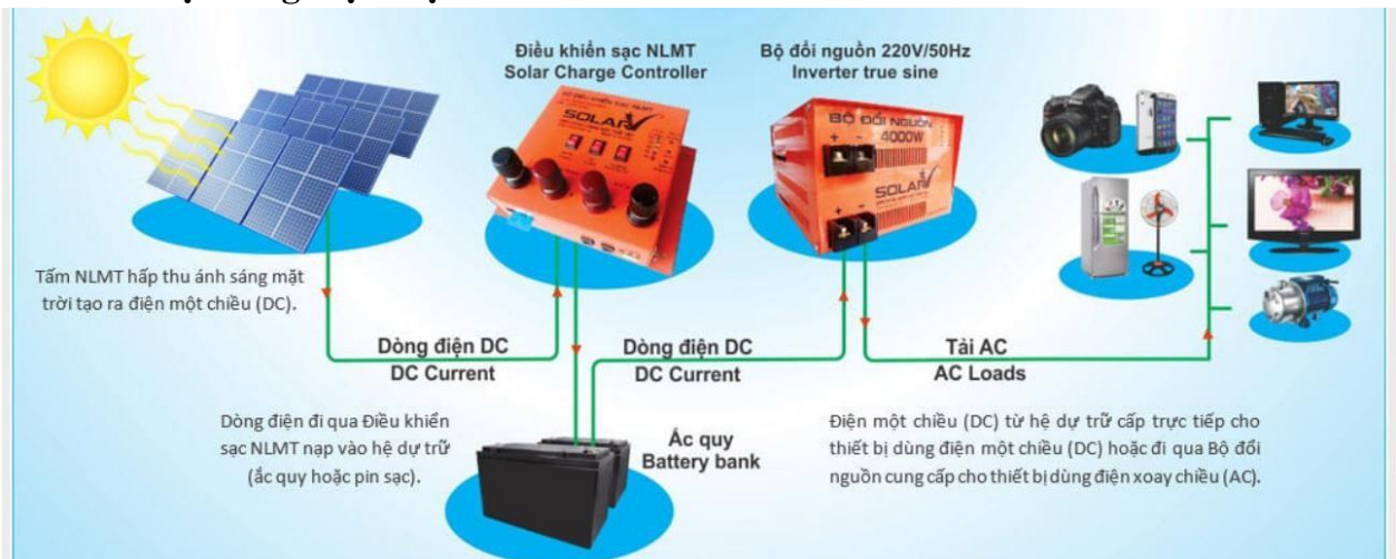
Hình 3.3: Sơ đồ hệ thống điện mặt trời
