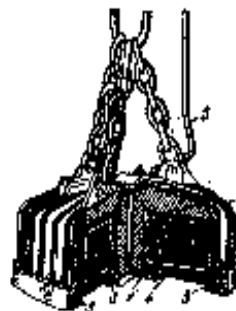
HÌNH 1.25: HÌNH DẠNG CHUNG CỦA NAM CHÂM ĐIỆN NÂNG HẠ
