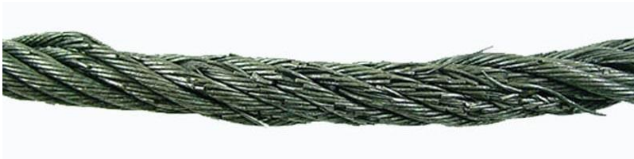
Hình 4.10 Cáp tời đang bị hư hỏng
