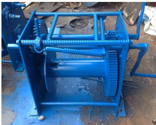
Hình 4.3 Hình dạng tời tay quay gắn trên sàn
