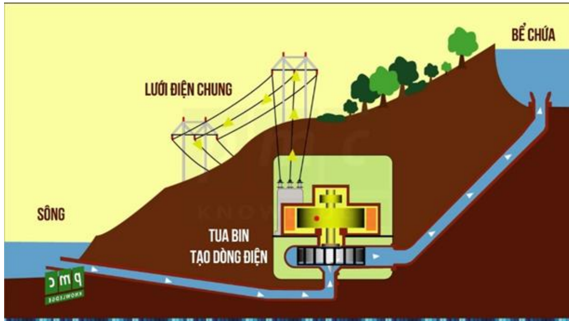
Hình 2: Hệ thống nhà máy thủy điện
