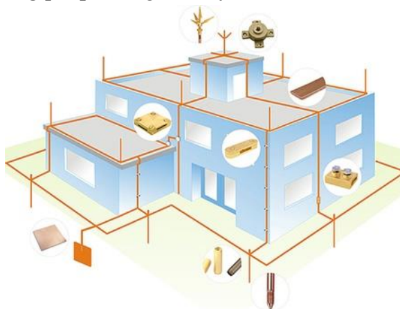
Hình 2.2.5: Chống sét trực tiếp theo phương pháp cổ điển.
