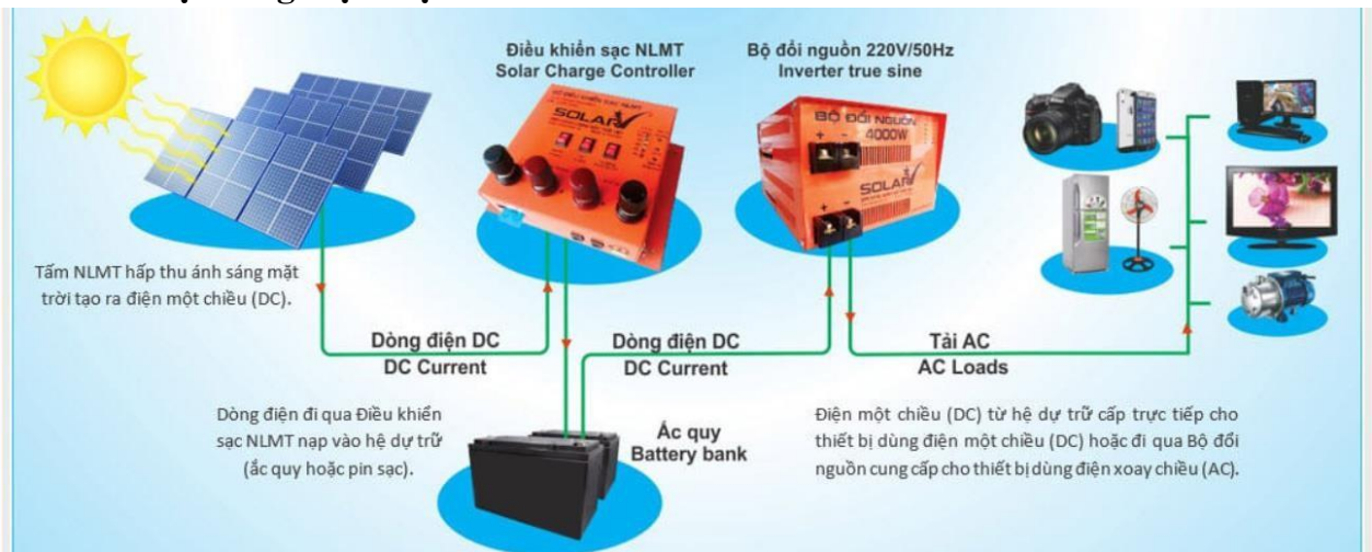
Hình 3.3: Sơ đồ hệ thống điện mặt trời
