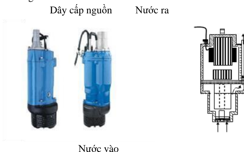
Hình 3-17. Cấu tạo của máy bơm chìm
