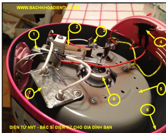
Hình 1.6. Cấu tạo bên trong nồi cơm điện.
