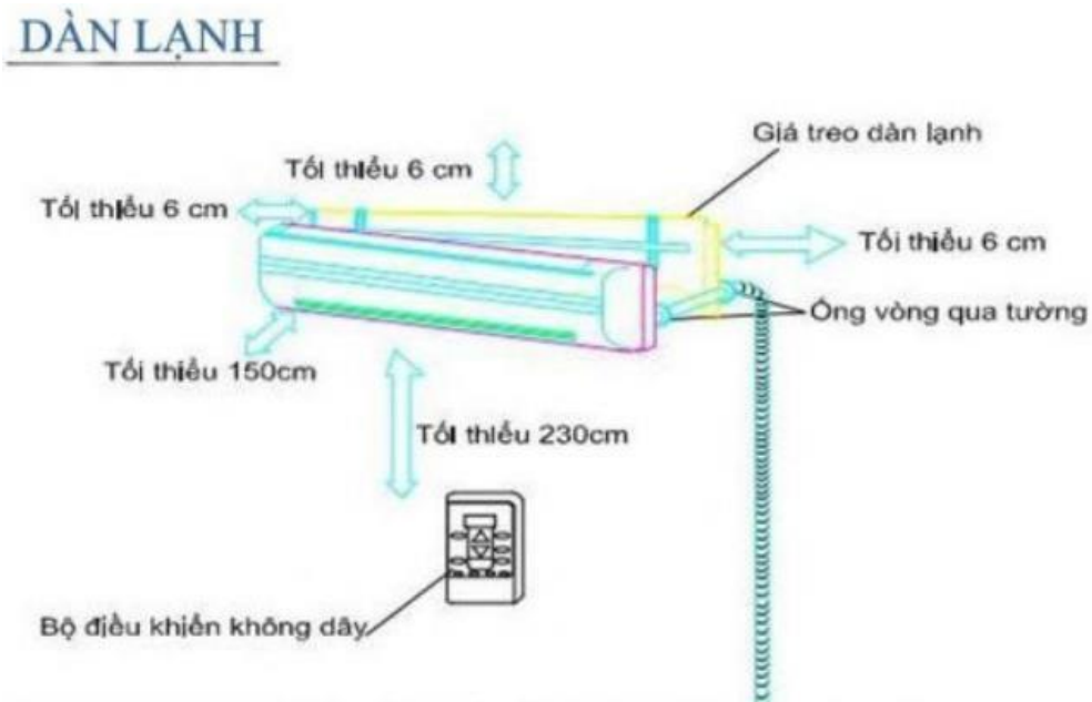
Hình 11.5: Lắp đặt dàn lạnh.
