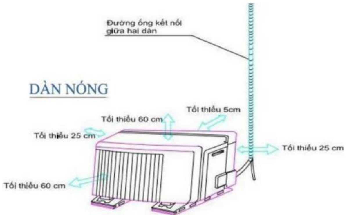
Hình 11.6: Lắp đặt dàn nóng.
