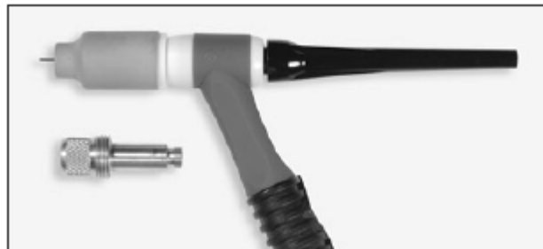
Hình 4.10 : đầu hàn sử dụng ống hội tụ để giảm sự cuộn xoáy của dòng khí bảo vệ Nguồn hàn
