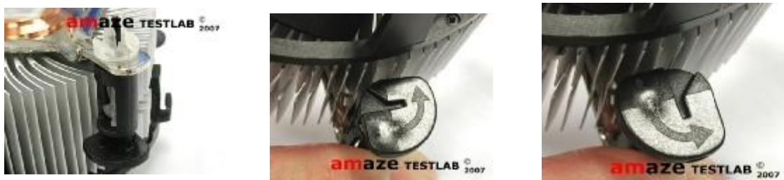
Hình 1.21: Kiểm tra các chốt khóa quạt CPU
