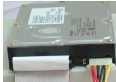
Hình 1.39: Cách lắp cáp dữ liệu và cáp nguồn cho ổ đĩa cứng
