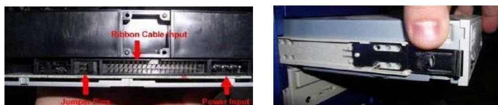
Hình 1.47: Vị trí lắp cáp dữ liệu và cáp nguồn cho ổ đĩa CD
