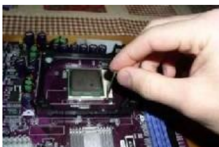
Hình 1.23: Gạt thanh giữ CPU
