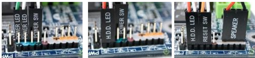
Hình 1.52: Cách lắp các đầu dây công tắc của Case
