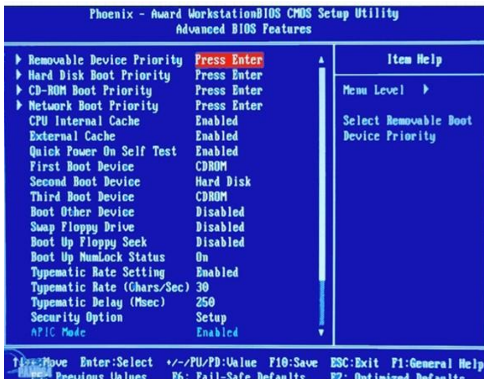
Hình 2.5: Cửa sổ BIOS FEATURES SETUP (ADVANCED CMOS SETUP)
