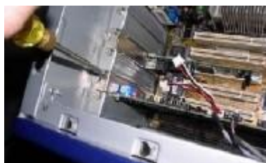
Hình 1.29: Lắp vít cố định Card
