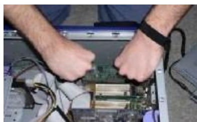
Hình 1.28: Lắp Card vào thùng máy
