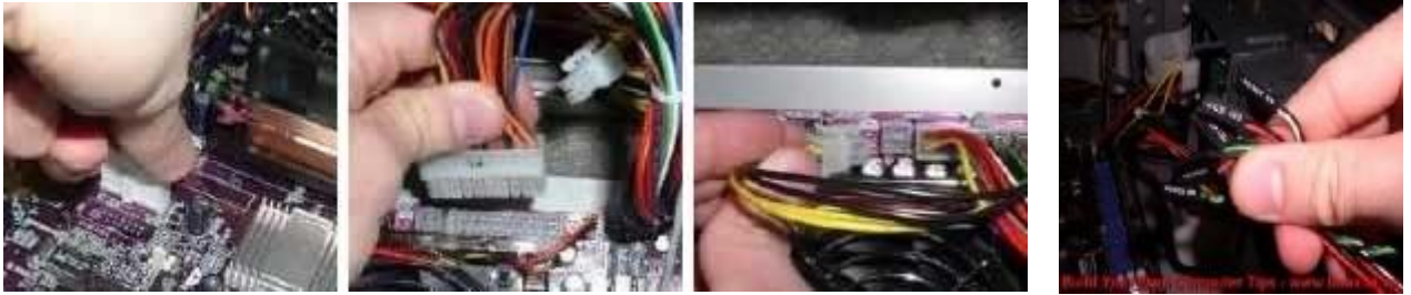
Hình 1.17: Lắp các đầu dây vào main
