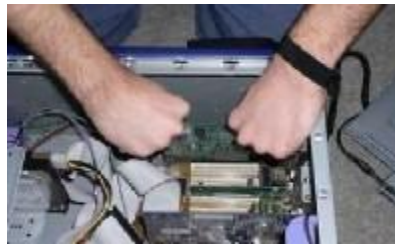
Hình 1.28: Lắp Card vào thùng máy
