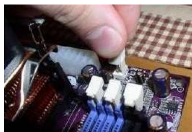
Hình 1.26: Lắp dây nguồn quạt CPU
