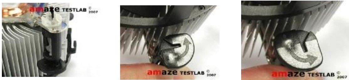
Hình 1.21: Kiểm tra các chốt khóa quạt CPU
