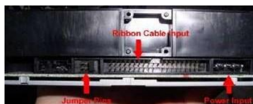
Hình 1.47: Vị trí lắp cáp dữ liệu và cáp nguồn cho ổ đĩa CD
