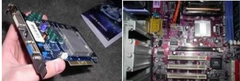
Hình 1.27: Chuẩn bị Card lắp vào thùng máy Gắn Card vào khe cắm và dùng tay nhấn thẳng Card vào khớp với khe cắm.
