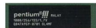
Nhãn CPU ghi 1000/256/133/1.7V nghĩa là Tốc độ 1000MHz /Cache L1: 256K / Bus 133 / Vcc 1,7V
