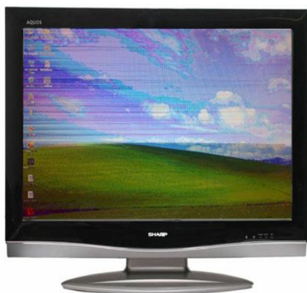
Hình 1.4.13: Màn hình bị sai màu, hình ảnh bị lang ben.
