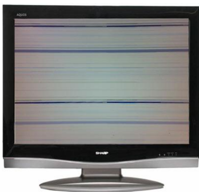
Hình 1.4.13: Bị mất ảnh, trên màn hình chỉ còn các đường sọc đen trắng ngang màn hình.
