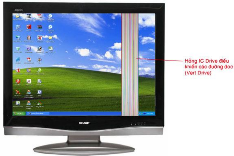
Hình 1.4.5: Màn hình bị mất một phần hình ảnh dọc màn hình
