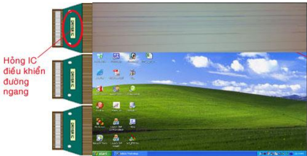
Hình 1.4.8: Hồng IC điều khiển đường ngang sẽ dẫn đến mất một phần hình ảnh ngang màn hình
