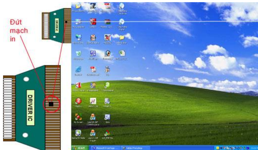
Hình 1.4.4: Nguyên nhân của đường kẻ ngang không đổi màu sắc là do đứt mạch ở sau IC Drive hoặc đứt trên màn hình
