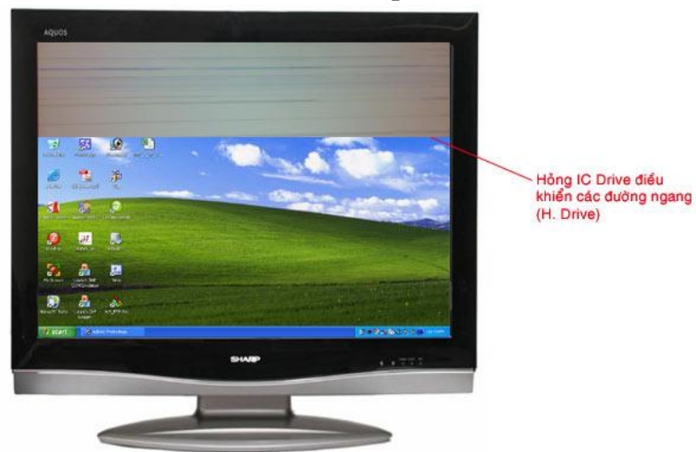
Hình 1.4.6: Màn hình bị mất một phần hình ảnh ngang màn hình
