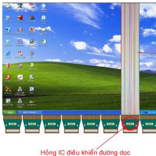
Hình 1.4.7: Hỏng IC điều khiển đường dọc sẽ dẫn đến mất một phần hình ảnh dọc màn hình
