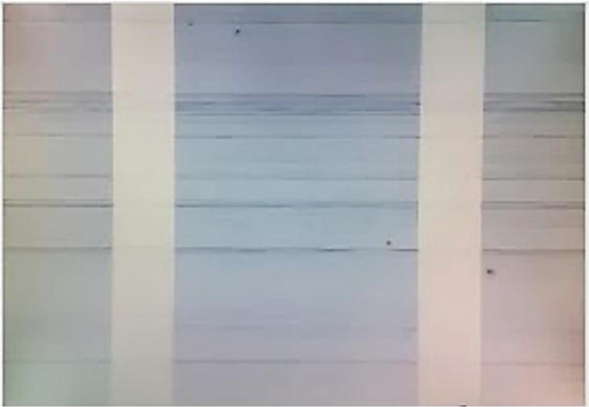
Hình 7.16: Hiện tượng mất hoàn toàn hình ảnh.
