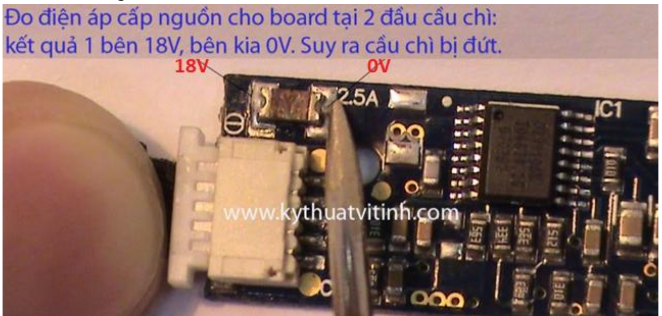
Hình 7.22: Kiểm tra bo cao áp
