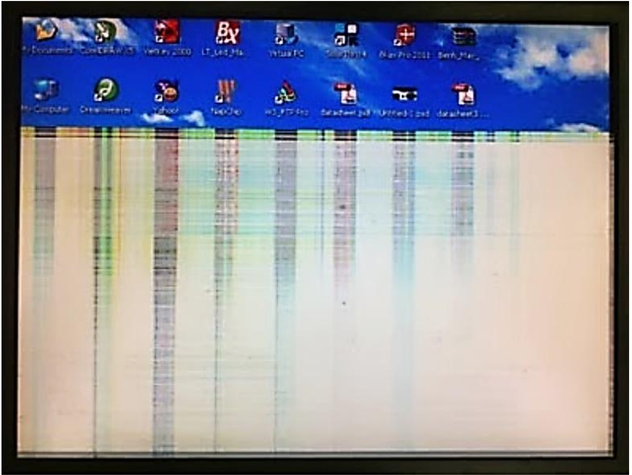
Hình 7.19: Hiện tượng hỏng V.Drive hoặc hỏng các IC
