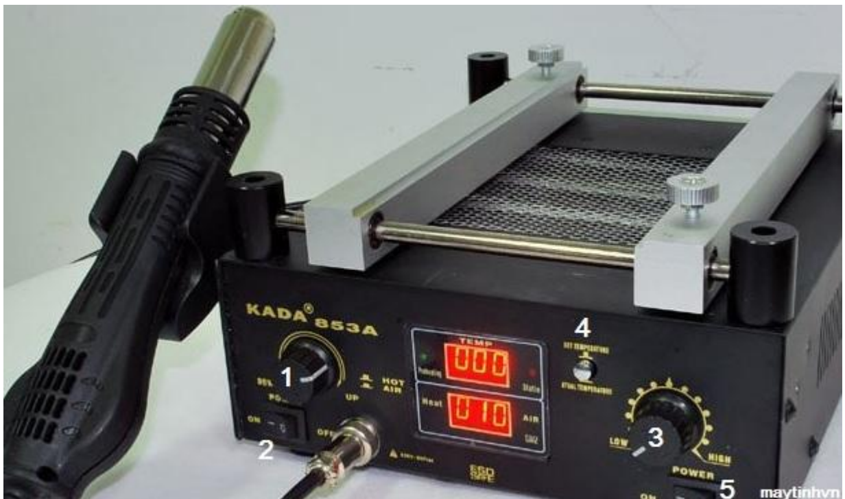
Hình 4.4: Máy hàn chipset KADA 853A
