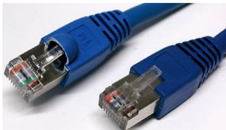
Hình 1.21: Cáp RJ-45 dùng để kết nối máy tính với mạng LAN
