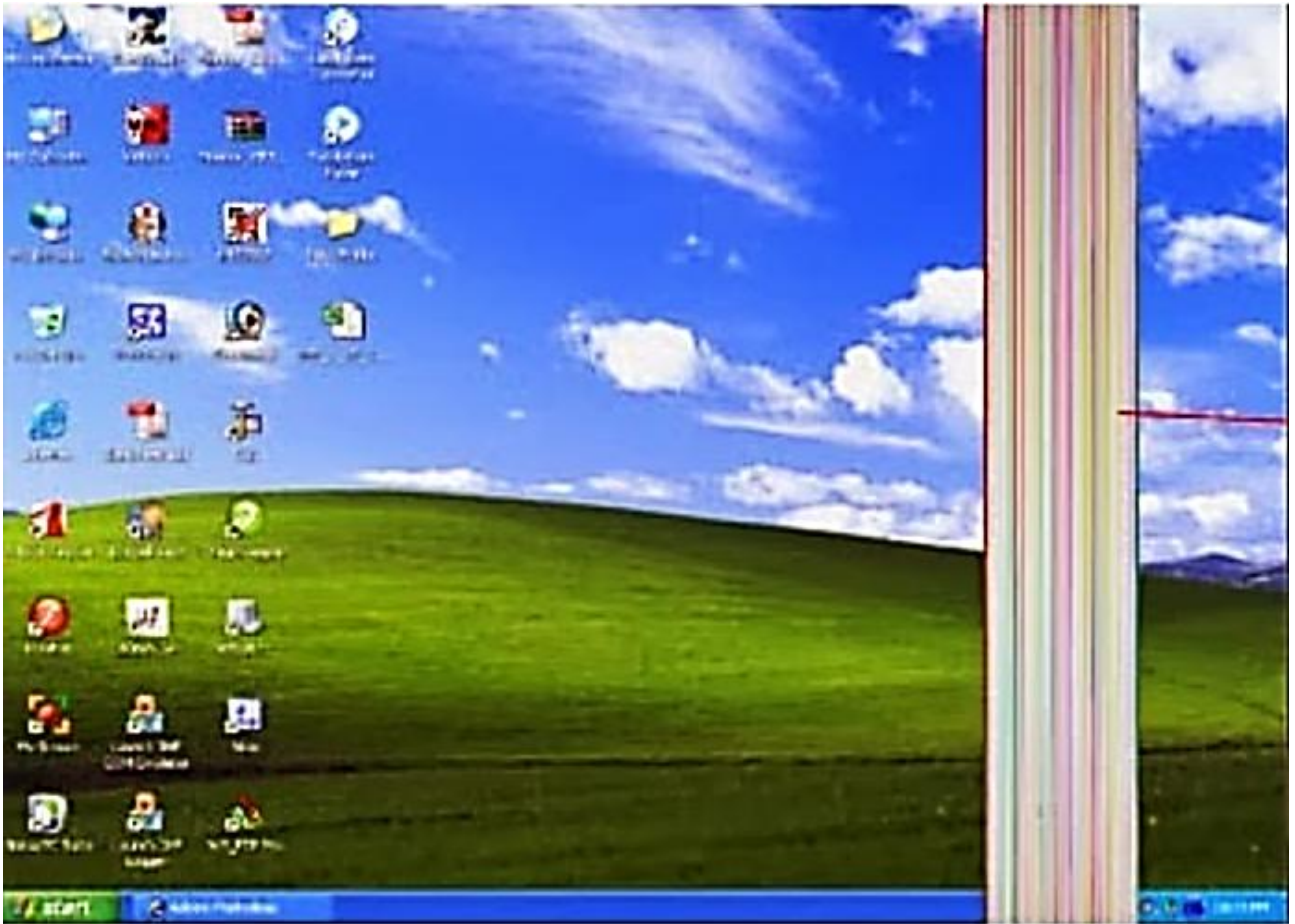
Hình 7.20: Hiện tượng hỏng V.Drive hoặc hỏng các IC
