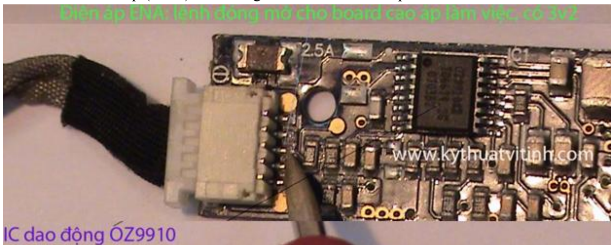
Hình 7.23: Kiểm tra bo cao áp
