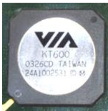
Hình 6.1: Chip cầu bắc VIA KT600 (đã bỏ bộ phận tản nhiệt)
