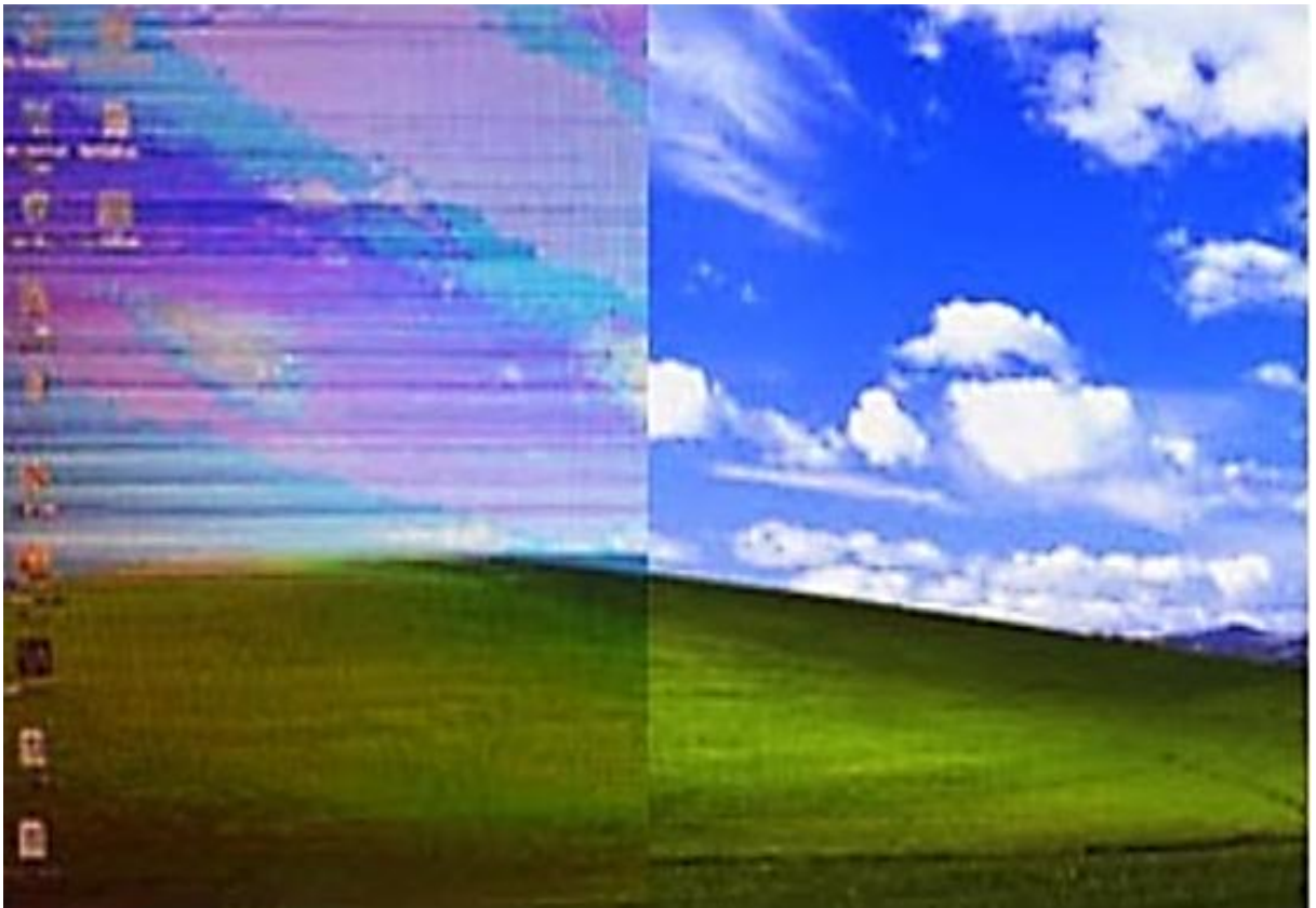
Hình 7.15: HIện tượng nhiễu màu hoặc mất hình trên một nửa màn hình.
