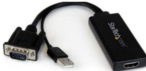
Hình 1.14: Cáp chuyển từ VGA sang HDMI:
