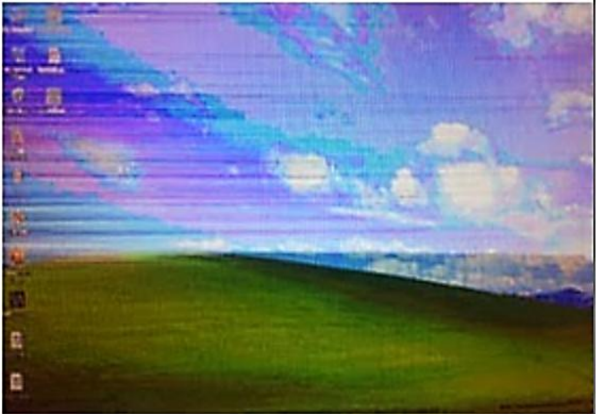
Hình 7.13: Hiện tượng nhiễu màu, hình ảnh như bị lang ben, màu lem nhem.
