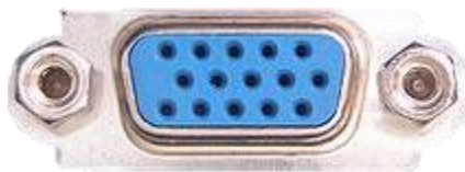
Hình 1.12: Cổng VGA, có 15 chân tiếp xúc
