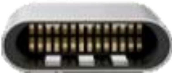
Hình 1.19: Cổng USB – C không phân biệt chiều cắm của thiết bị.
