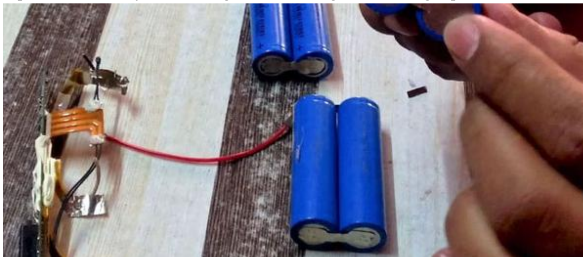
Hình 8.7: Lấy cell của pin ra
