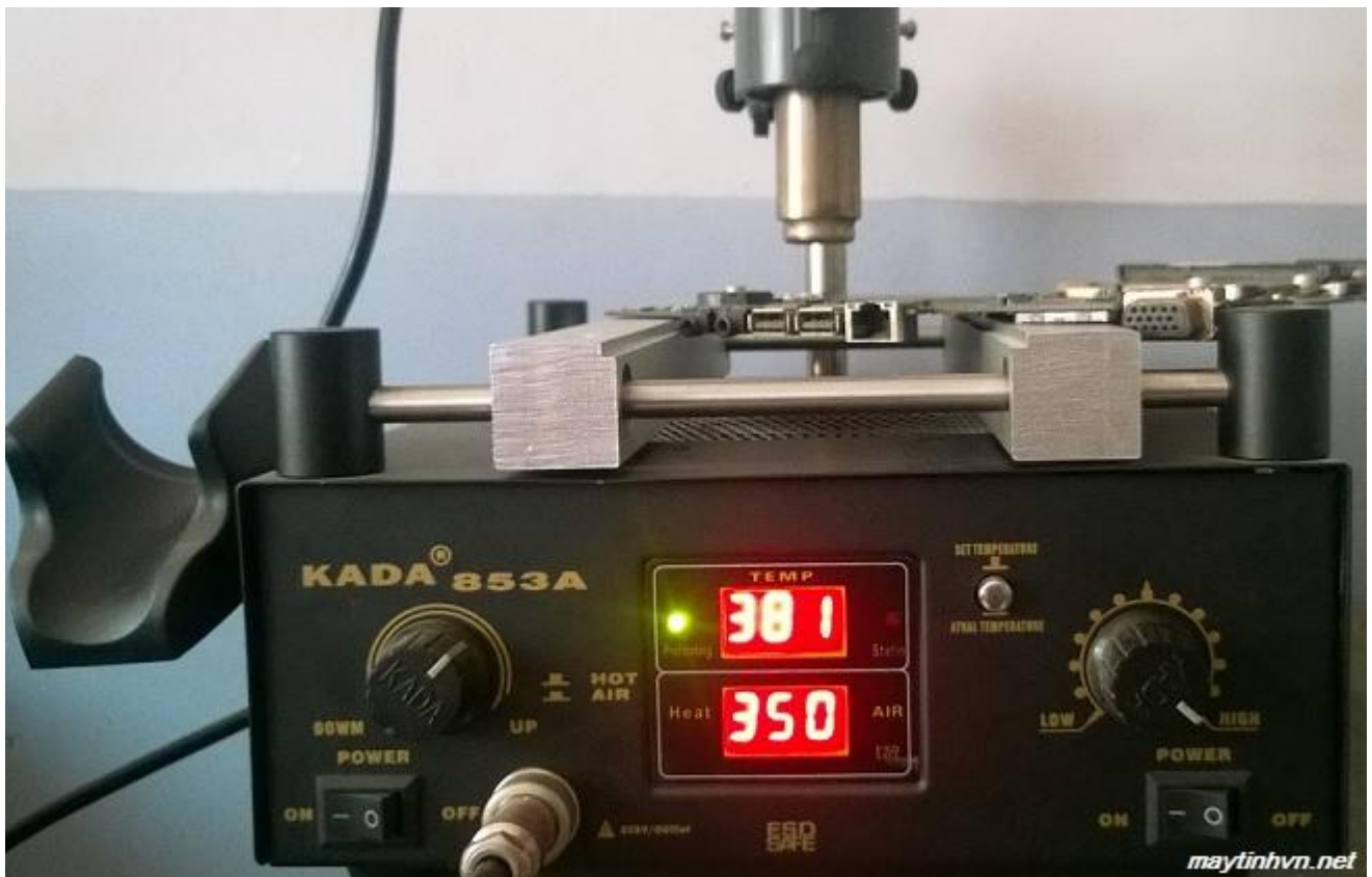
Hình 4.5: Thay chipset bằng KADA 853A
