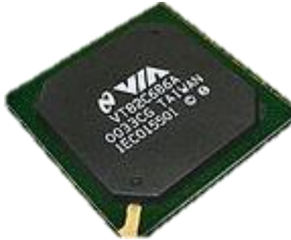
Hình 6.2: Chip cầu nam VIA 686A
