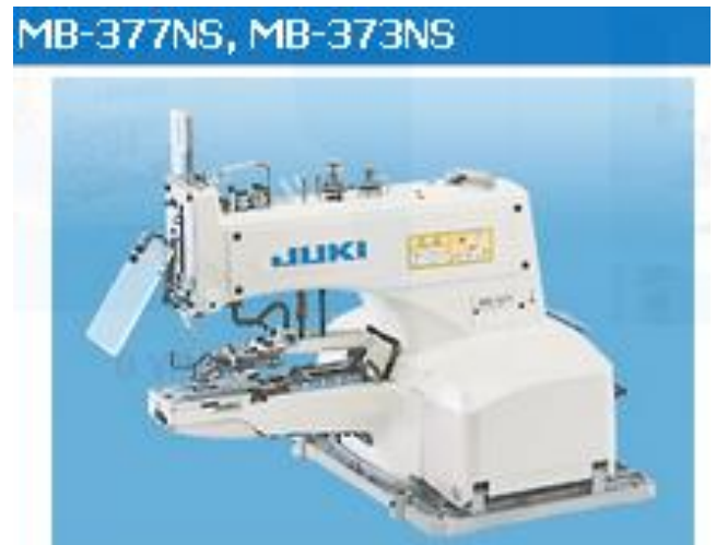
Hình 6.2. Hình dạng các loại máy đính cúc
