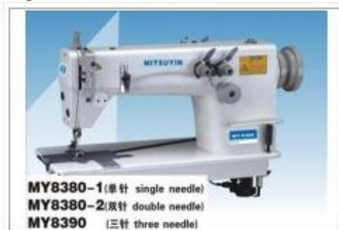
Hình 6.3. Máy hai kim móc xích
