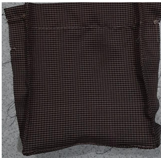
Hình 5.8: May điều cạnh túi
