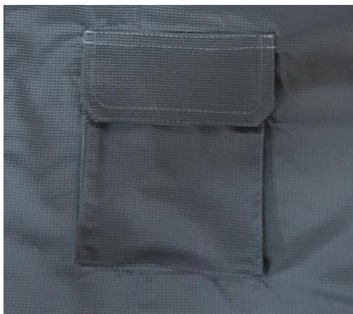
Hình 5.12: May điều nắp túi.
