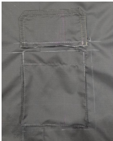
Hình 5.11: May nắp túi vào thân sản phẩm.
