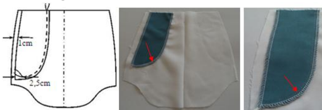
Hình 3.31: May đáp sau vào lót túi sau
