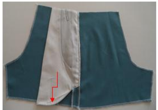
Hình 3.40: Điều đáy túi.
