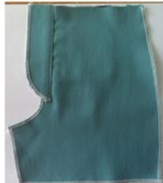
Hình 3.44: điều mí 1mm.
