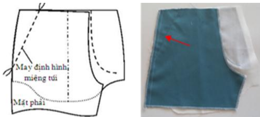
Hình 3.32: May định hình miệng túi thân trước.
