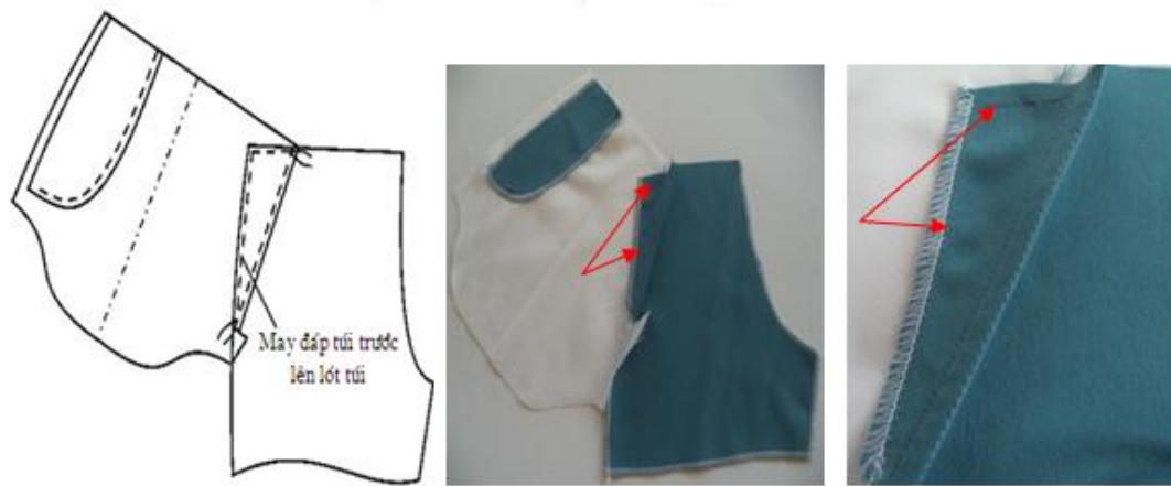
Hình 3.35: May đáp túi trước lên lót túi.
