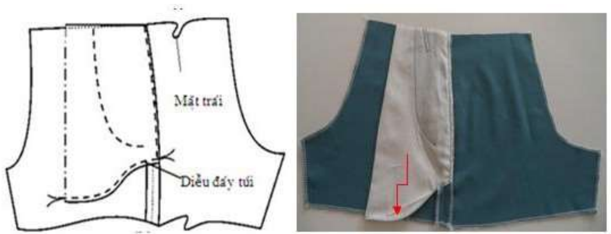
Hình 5.34: Điều đáy túi.
