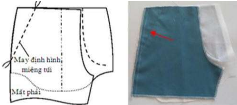
Hình 5.26: May định hình miệng túi thân trước.
