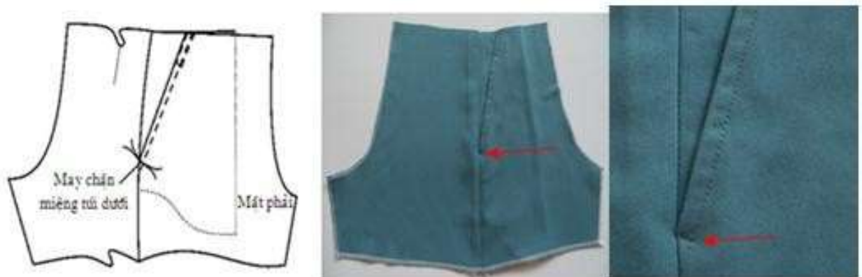
Hình 5.35: May chặn miệng túi dưới.
