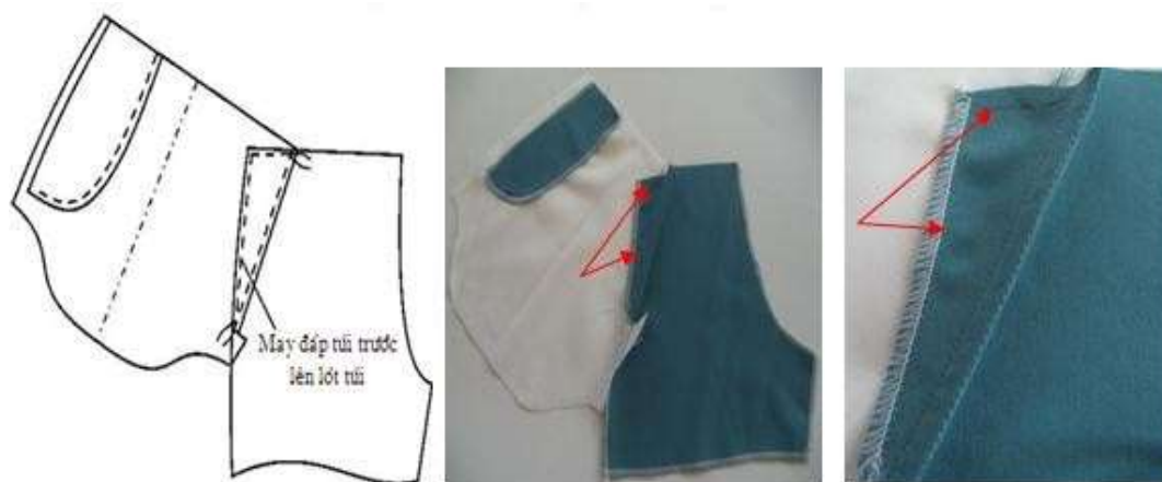
Hình 5.29: May đáp túi trước lên lót túi.
