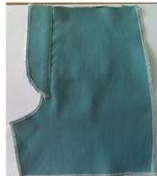
Hình 5.38: điều mí 1mm.
