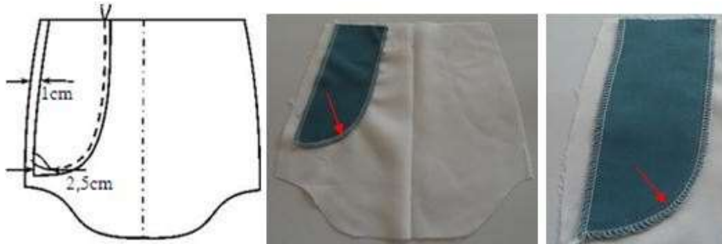
Hình 5.25: May đáp sau vào lót túi sau
