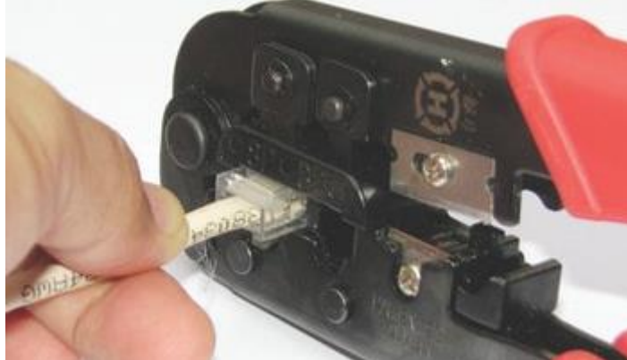
Hình 7.12 Tiến hành bấm dây mạng bước 6
