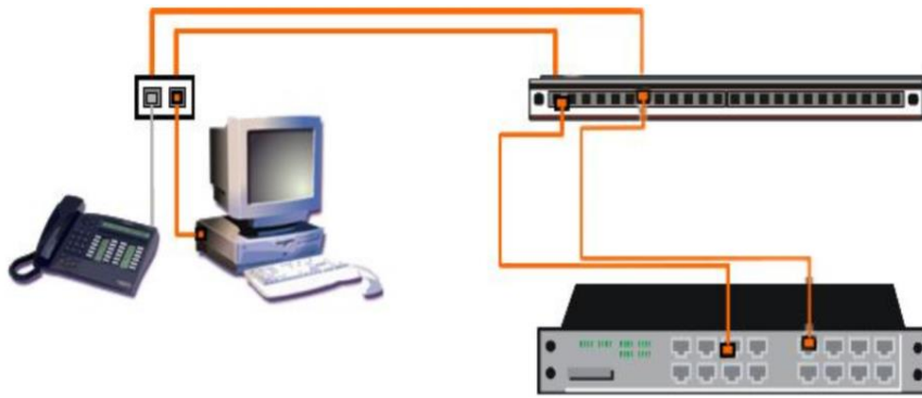
Hình 7.2 lắp đặt cáp ngang
